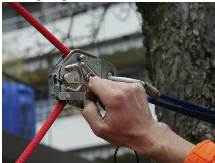
Installationsart: Rig to rescue: Die mitgelieferte Seilspannvorrichtung (Längeneinstellvorrichtung) ist gleichzeitig mit einer Ablassfunktion ausgerüstet. Eine abgestürzte Person kann so in den meisten Fällen vom Retter am Boden abgelassen werden.
