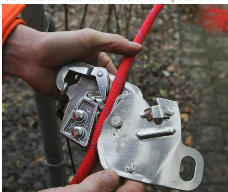
Mitlaufendes Auffanggerät EN353-2 mit EN341 Ablassfunktion (Rettung)
